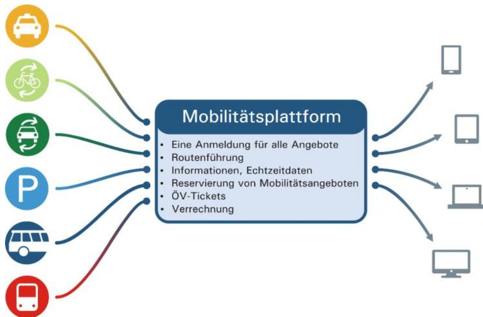
Abbildung 21: Aufbau einer Mobilitätsplattform
