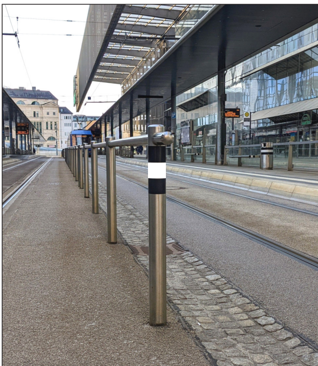
Abbildung 5: Gestaltung von Pollern mit Wechselkontrast
