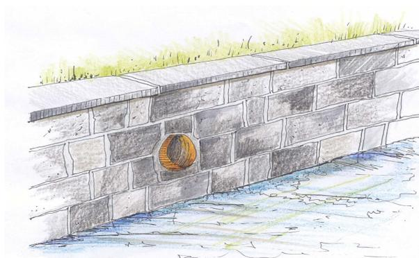
**Abbildung 3:** Einleitstelle in einer Ufermauer.
