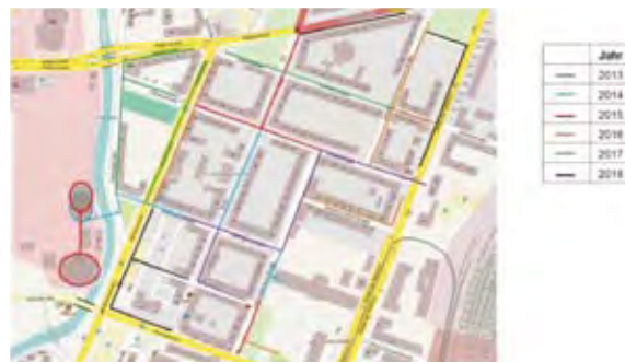
Plan des Ausbaus des Fernwärmenetzes bis 2018
