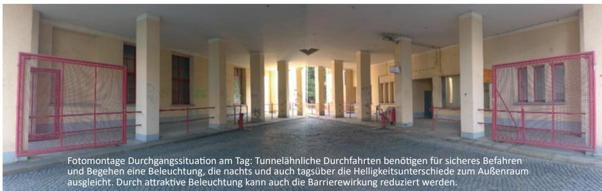
Fotomontage Durchgangssituation am Tag: Tunnelähnliche Durchfahrten benötigen für sicheres Befahren und Begehen eine Beleuchtung, die nachts und auch tagsüber die Helligkeitsunterschiede zum Außenraum ausgleicht. Durch attraktive Beleuchtung kann auch die Barrierewirkung reduziert werden.
