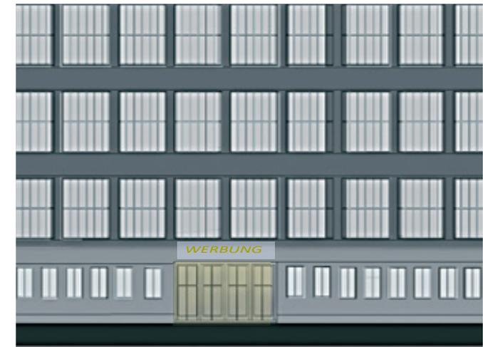
Ansicht von Alchemnitzer Stra&uuml;e, Beleuchtungsziele: Differenzierte Farbtemperatur und Helligkeit des Eingangs, erh&ouml;hte Beleuchtungsst&uuml;rke
