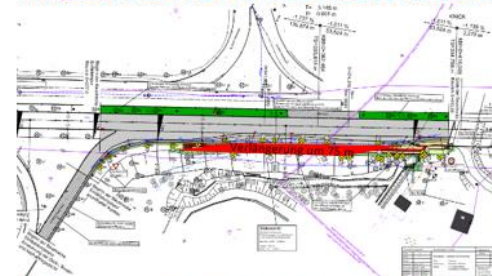
Verlängerung Einfädelsstreifen auf 120 m Länge durch Herstellung einer 100 m langen Stützwand
